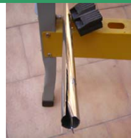
Les dues parts tornaran a encaixar gràcies a aquests doblecs.
