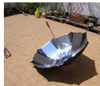
El punt focal és la zona del pal principal on confueixen tots els rajos solars
